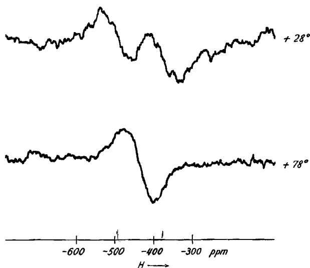
^{17}\text{O} -Kernresonanzspektren von Benzofurazanoxid bei verschiedenen Temperaturen (Konzentrierte Lösungen in \text{CHCl}_3 , natürliche Häufigkeit von ^{17}\text{O} ) Resonanzfrequenz: 7,65 MHz; Modulationsfrequenz: 40 Hz. Chemische Verschiebungen in ppm, bezogen auf \text{H}_2^{17}\text{O} = 0 ppm.
